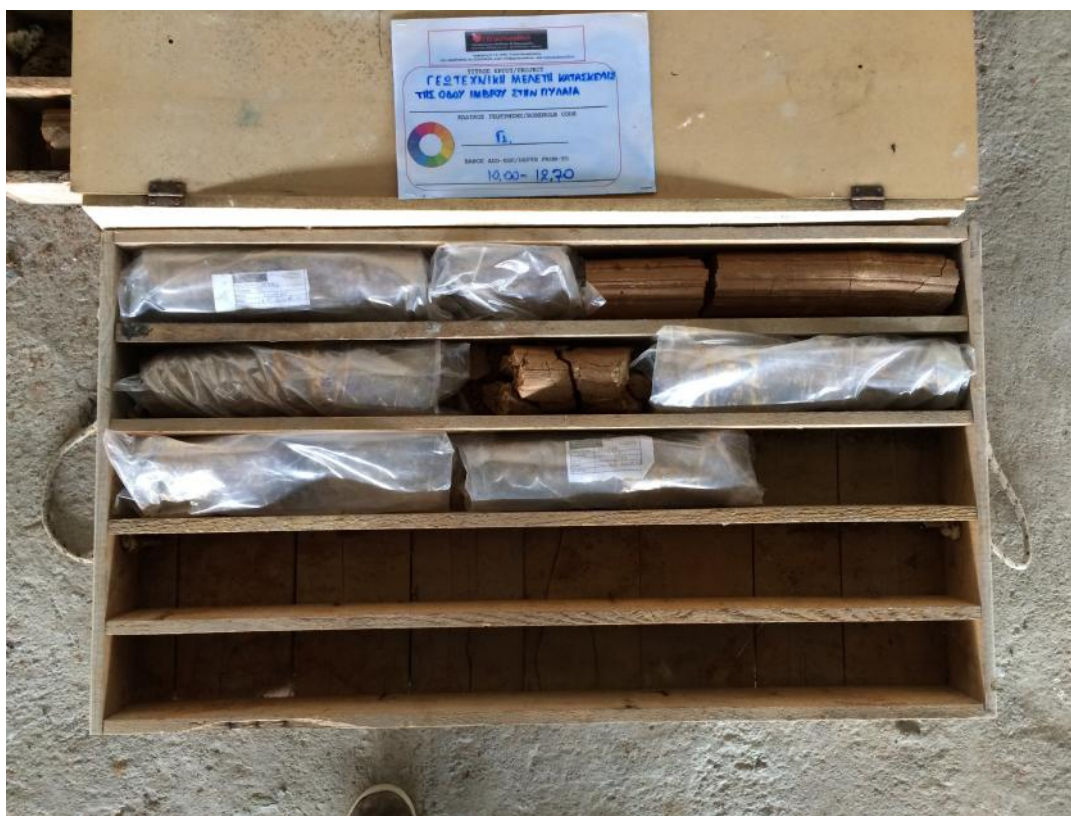
Φωτογραφία 5. Αποτύπωση θέσης γεώτρησης Γ 2 . (Βάθος 10,00-12,70)
