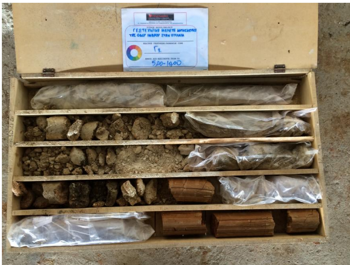
Φωτογραφία 7. Αποτύπωση θέσης γεώτρησης Γ 2 . (Βάθος 5,00-10,00)
