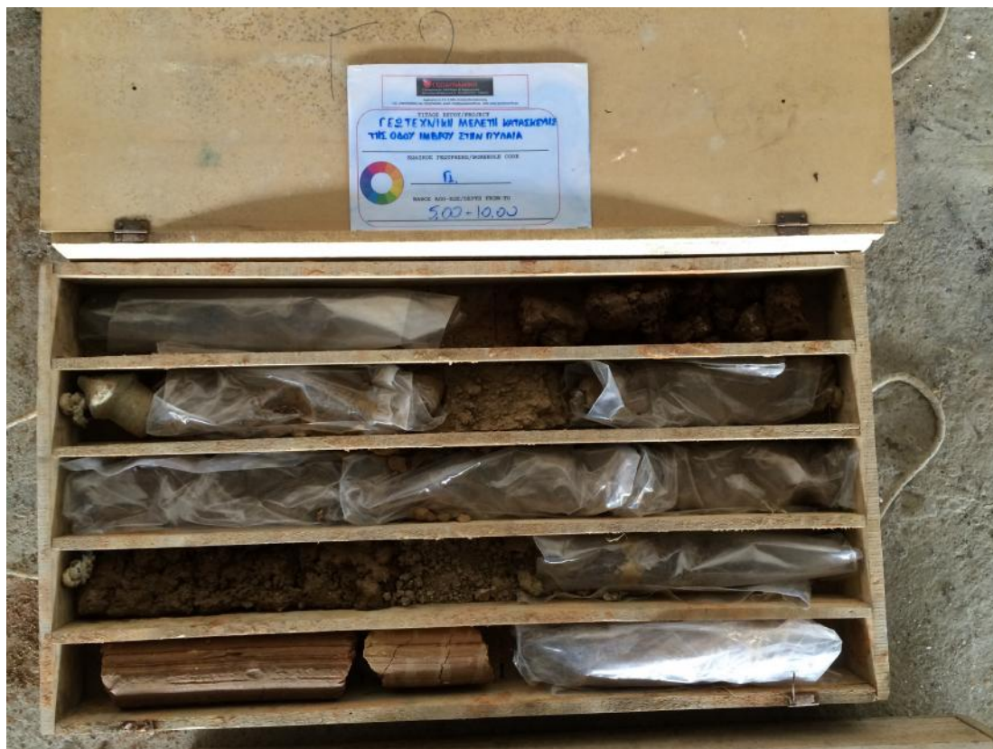
Φωτογραφία 4. Αποτύπωση θέσης γεώτρησης Γ 1 . (Βάθος 5,00-10,00)
