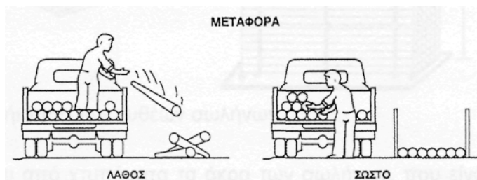
Σχήμα 5: Ανορθόδοξος και σωστός τρόπος φορτοεκφόρτωσης σωλήνων.
