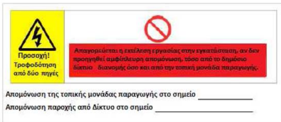
Σχήμα 5: Παράδειγμα προειδοποιητικής σήμανσης για σύνδεση μονάδας παραγωγής εντός της εγκατάστασης κατανάλωσης του αυτοπαραγωγού.
