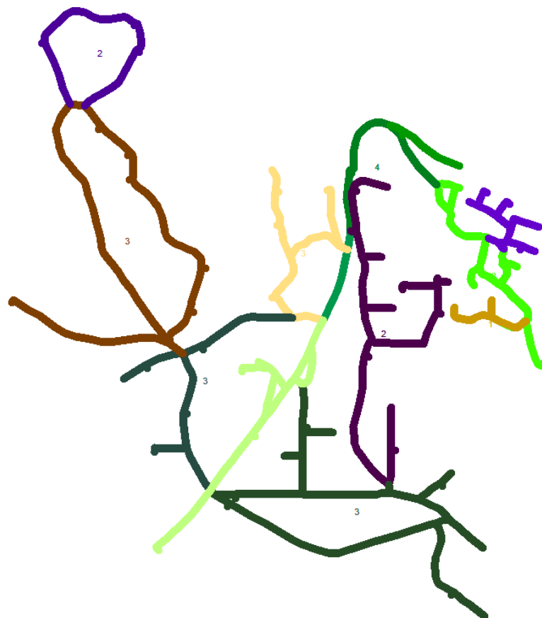
Σχήμα 2.62 Έντεκα (11) υποζώνες απομόνωσης ζώνης υδροδότησης δεξαμενής Παυλίδη 1
