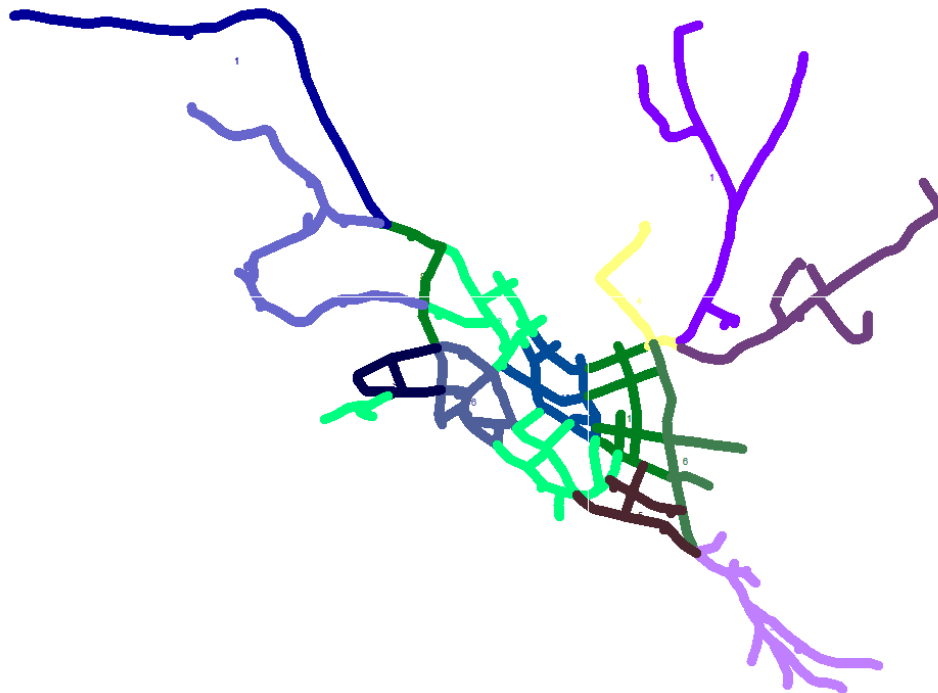
Σχήμα 2.61 Δεκαπέντε (15) υποζώνες απομόνωσης ζώνης υδροδότησης δεξαμενής Πύργου 500
