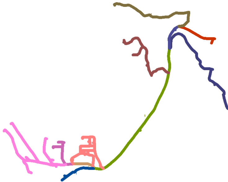
Σχήμα 2.63 Εννέα (9) υποζώνες απομόνωσης ζώνης υδροδότησης δεξαμενής Παυλίδη 2
