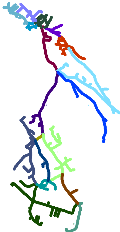
Σχήμα 2.64 Δεκαεπτά (17) υποζώνες απομόνωσης ζώνης υδροδότησης δεξαμενής Ψωμά
